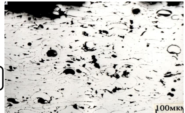
газо-термическое покрытие с порами
