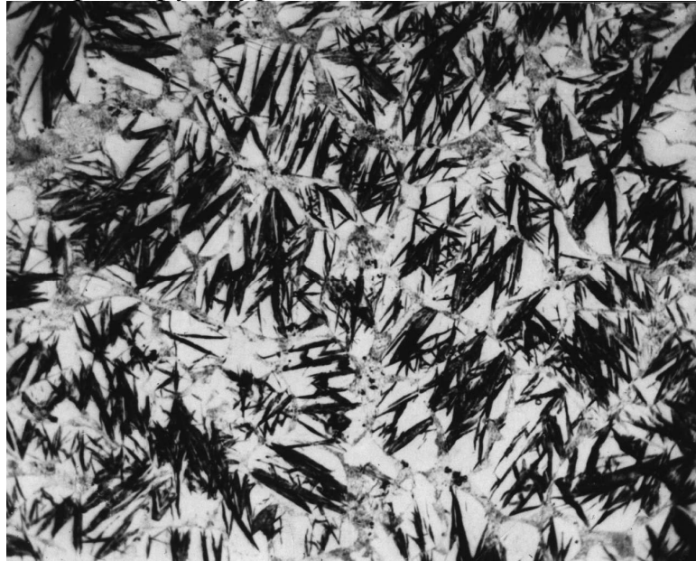
микроструктура стали 45 после закалки
