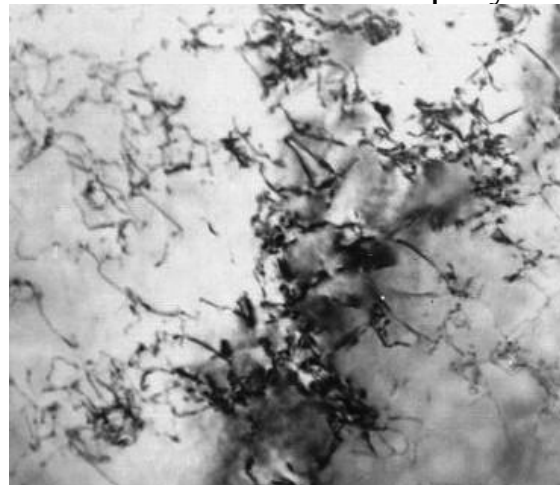
дислокационная структура в ферритном зерне стали 20
